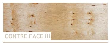
Face ouverte, non réparée, admettant trous de nœuds et fentes
